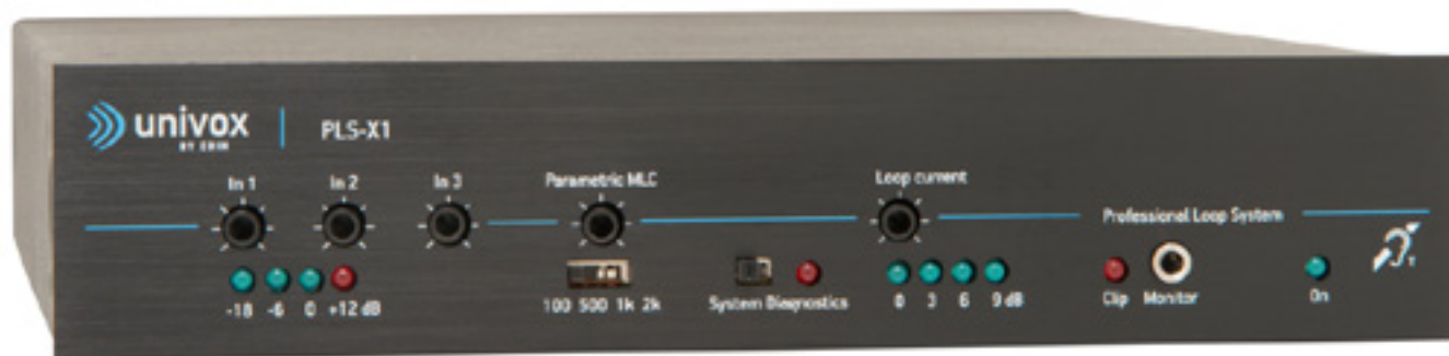
Mynd 57. Gaumljós og stjórnhnappar á Univox PLS-X1.
