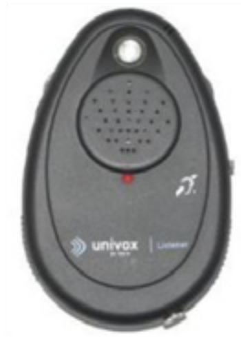
Mynd 8. Univox Listener er sérlega einfalt stjórntæki fyrir tónmökva
