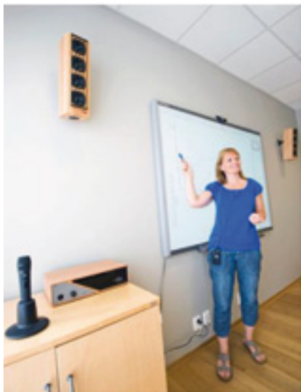
Mynd 4. Grunneining fyrir Audiolink, ásamt tveimur hátalarasúlum sem dreifa hljóðinu jafnt um rýmið. Heimild: Vestfold Audio a.s.
