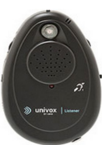
Mynd 28. Univox Listener er einfalt prófunarmælitæki með tengli fyrir heyrnartól og ljósi sem kviknar til að sýna að tónmöskvinn starfi rétt.
