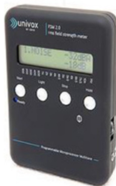
Mynd 7. Segulstyrkmælirinn Univox FSM 2.0 er notaður til að mæla og kvarða styrk tónmökva með hliðsjón af IEC-staðlinum
