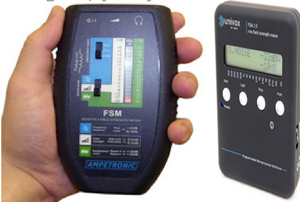
Mynd 27. Hér sjást tveir drægismælar sem notaðir eru við vottun tónmöskva. Til vinstri er Ampetronic FSM og til hægri Univox FSM 2. Mikilvægt er að halda tækjunum lóðréttum og í réttari hæð þegar mælt er.
