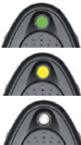
Mynd 29. Grænt ljós táknar að tónmöskvinn sé stilltur í samræmi við IEC- viðmiðið. Gult ljós táknar að tónmöskvinn virki en sé ekki stilltur í samræmi við IEC-viðmiðið. Ef ekkert ljós kviknar virkar tónmöskvinn alls ekki. Munið að nota heyrnartólin til að kanna hljóm-gæðin.
