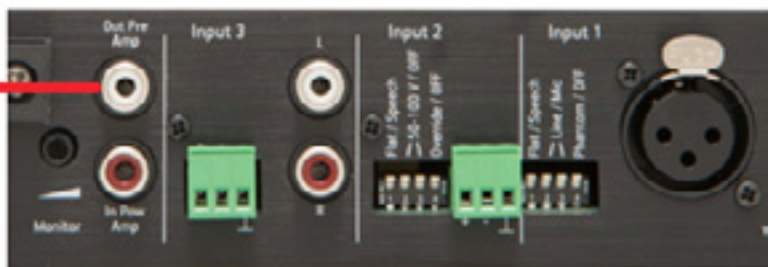
Mynd 52. Hér má sjá afturhlið tónmöskvamagnarans PLS-XI betur, með tenginu sem merkt er „Out Pre Amp“. Þetta er tengið fyrir virka hátalarann. Um þetta úttak er sent línumerki sem samsvarar merkinu sem fer til tónmöskvans.
