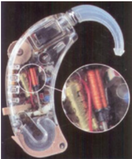
Mynd 6. Heyrnartæki með T- spólu. Tækið á myndinni er með gegnsærri hlíf og því sést tónspólan, sem nemur hljóðið þegar tækið er í T-stillingu, greinilega.
