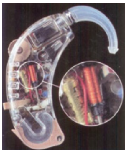
Figur 6. Hörapparat med telespole. Här är höljet genomskinligt så att vi kan se själva telespolen som fångar upp ljudet i T-läge.
