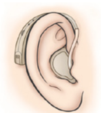
Figur 1. Här ser vi hur en stöpt propp täpper till hörselgången så att allt ljud går via hörapparaten.
