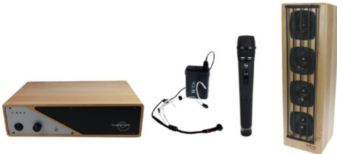
Figur 58. Det här är huvudkomponenterna i Audiolink-anläggningen – från vänster basstation, trådlöst mikrofonsystem med headset-mikrofon, trådlös handhållen mikrofon och högtalare. Basstationen innehåller trådlösa mottagare och en förstärkare för högtalarna. Den mixar signalerna från de olika ingångarna och ger en konstant signalstyrka till slingförstärkaren.
