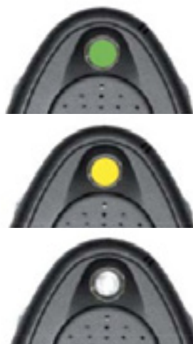
Figur 29. Grönt ljus indikerar att teleslingan är i enlighet med IEC-standarden. Gult ljus indikerar att teleslingan fungerar men inte är i enlighet med IEC-standarden. Om lampan inte lyser fungerar inte teleslingan. Kom ihåg att använda hörlurar för att kontrollera ljudkvaliteten.
