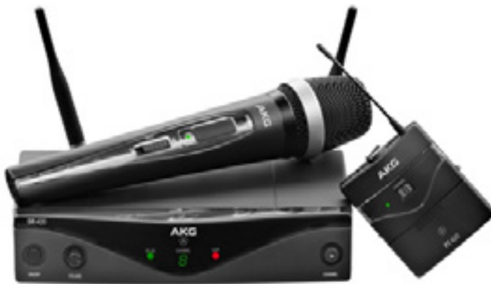
Figur 41. Trådlös utrustning från AKG med en tvåkanalig mottagare, en handhållen mikrofon och en sändare att ha i fickan. Produkten som visas är AKG WMS 420. Det här standardpaketet levereras med en dynamisk mikrofon i den handhållna enheten. Därför fungerar paketet, som förklarats tidigare, INTE så bra tillsammans med en teleslinga.
