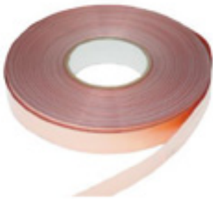
Figur 17. Foliekabel som är 25 mm bred och 0,1 mm tjock och motsvarar en rund kabel med tvärsnittsarean 2,5 \text{ mm}^2 . Källa Bo Edin AB (Univox)
