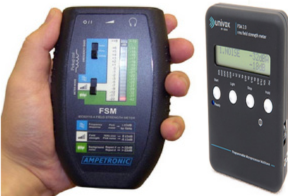
Figur 27. Här visas två fältstyrkemätare för certifiering av teleslingor. Till vänster Ampetronic FSM och till höger Univox FSM 2. Det är viktigt att instrumenten hålls vertikalt och i rätt höjd vid mätningar.
