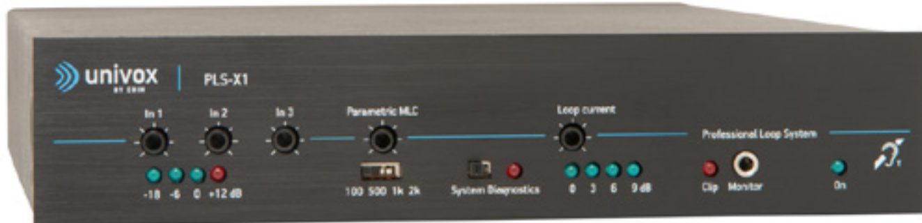
Figur 57. Indikatorlampor och kontrollfunktioner på Univox PLS-X1.
